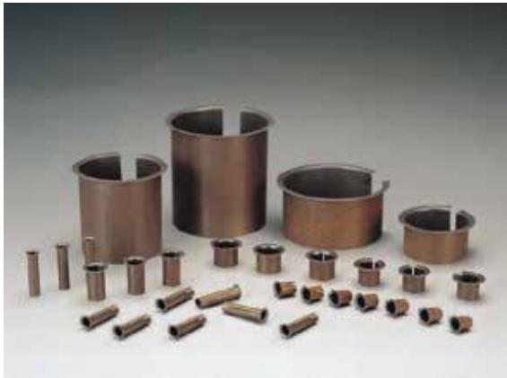
FR 以金属网为基材，表面附着以PTFE为主的耐磨材料。产品广泛运用化工行业、食品工业、汽机车、办公机械、纺织机械、汽车门铰链风轻载但需要自润滑材料，可运用于不同的领域。这种产品更容易于安装。
